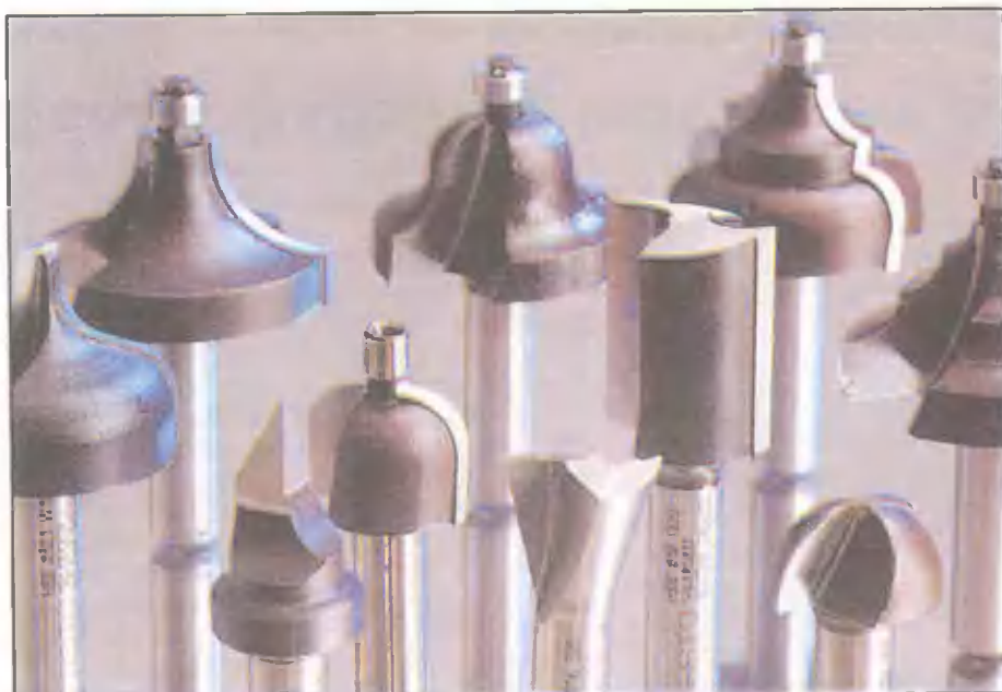
Некоторые виды фрез для обработки дерева.
