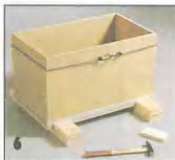
Если детали по углам ящика выступают, их положение подправляют легкими ударами молотка через деревянную подкладку.
