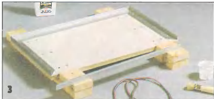
Размеры приспособления для склеивания равны размерам задней стенки ящиков. Чтобы легче отделить приспособление после отверждения клея, один из длинных уголков не закрепляют.
