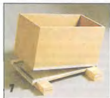
Когда клей затвердеет, ящик вынимают из приспособления. Если незакрепленный уголок не поддается, его можно поддеть отверткой.
