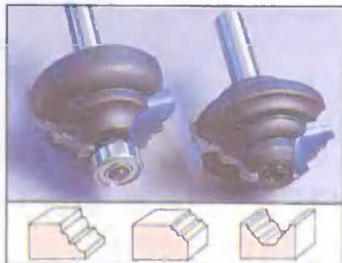
Профильные фрезы с упором и без него (соответственно слева и справа) для формирования декоративных кромок и пазов на деталях мебели, а также для обработки багетных планок.
