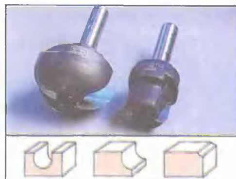
Фрезы для выборки калевок и полукруглых канавок могут быть без упора. В этом случае их положение относительно обрабатываемого материала задается упорами фрезерной машинки.
