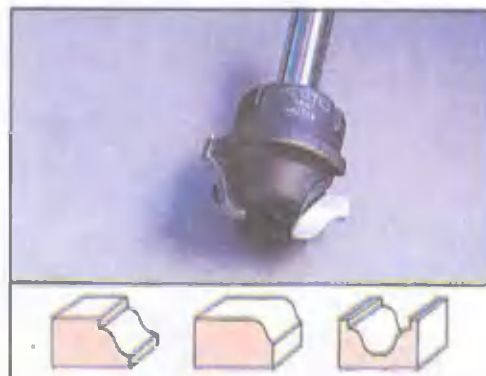
Радиус и форма скруглений определяется шириной и глубиной фрезерования и у двухрадиусных фрез. Сняв упор, многими из них можно выбирать и фигурные пазы.
