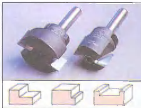
Фрезы для выборки фальцев. Внизу — возможные формы фальцев и пазов.
