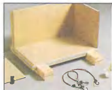
Нанеся клей на поперечные кромки, детали устанавливают в приспособление. При этом они самостоятельно смещаются в требуемое положение.
